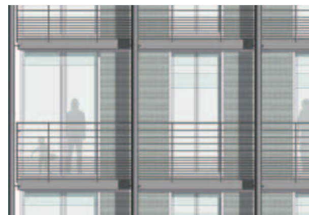
Image 3D détaillant le traitement de la façade.
